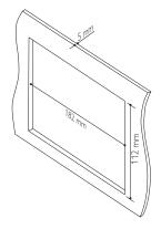
• 由於儀表板開口傾斜角超過 20 度時,裝置便無法使用:請確認汽車 儀表板開口的水平傾斜介於 0 到 20 度之間。 3 將裝置滑入儀表板,直到聽見咔噠聲。
